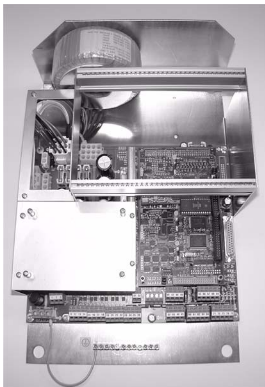
Fig. 3-4 Lambda transmitter LT2 på monteringsplatta 173 x 310 x 270 mm (H x B x T) typ 657 R 1030
